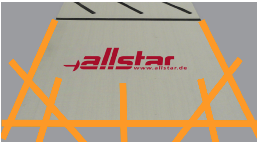
Kuva 3. Teippausmalli. Alueet kiinnitetään lattiaan teipillä vain päädyistään. Teippisuosituksena esim. Suomen 3M:n teippi 471. Teippiä ei saa liimattaessa venyttää, vaan se on kiinnitettävä mattoon ja alustaan ilman jännitystä.
